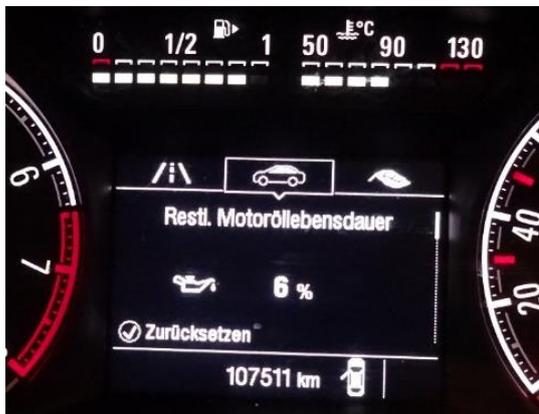
Die Informationssysteme im Display der Fahrzeuge geben Hinweise zur Wartung. So kann zum Beispiel folgende Meldung erscheinen: **Restl. Motoröllebensdauer 6%**. Diese Meldung bedeutet, dass sich die Qualität des Motoröls langsam einem Motorölwechsel nähert, es bedeutet nicht, dass der Ölstand zu niedrig ist.
