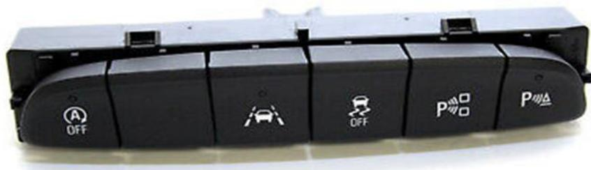
Wurde der Spurhalteassistent (Beispielbild, 3. Knopf von links) eingeschaltet, bleibt er auch nach einem zwischenzeitlichen Abstellen des Fahrzeugs und Ausschalten des Motors aktiv.
