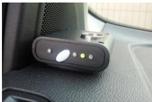
Am Schlüsselbund befindet sich ein Sender, der die berechtigte Buchung an den Bordcomputer des Fahrzeugs übermittelt und die Wegfahrsperre freischaltet. Angezeigt wird dies durch eine grüne Leuchtdiode am Bordcomputer. Starten Sie das Fahrzeug wie gewohnt mit dem Fahrzeugschlüssel (dabei das Kupplungspedal betätigen).
