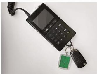
Den Bordcomputer samt Fahrzeugschlüssel finden Sie im Handschuhfach. Geben Sie ihre PIN über die Tastatur ein. Wenn Sie sich vertippen, korrigieren Sie mit der Taste „C“ links unterhalb des Displays. Jetzt können Sie den Datakey samt anhängendem Fahrzeugschlüssel aus der Halterung unterhalb der Tastatur des Bordcomputers nehmen und starten.
